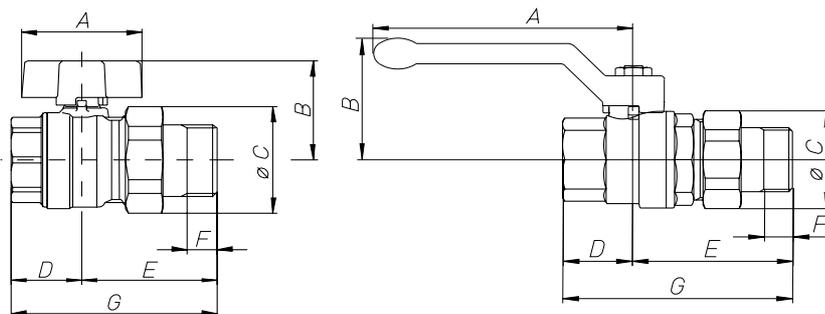
Кран шаровой полнопроходной с накидной гайкой и ниппелем («американка»), с рукояткой типа «бабочка» для  $D_y = 15-25$  мм и с ручкой для  $D_y = 32$  мм
