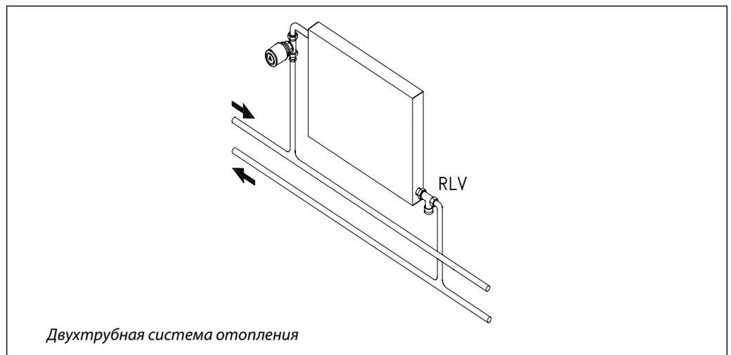
Двухтрубная система отопления
